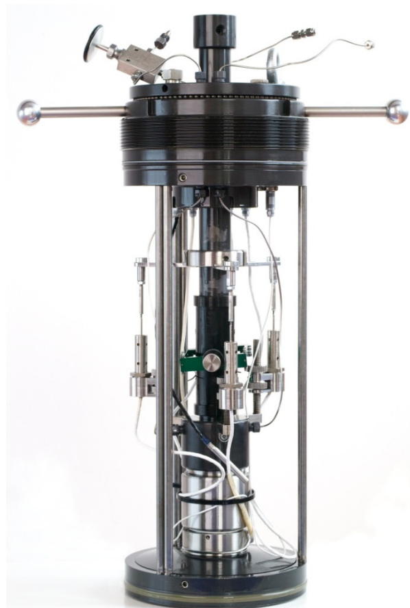
Aufbau für Triaxialprüfung mit Messung von Kraft sowie Axial- und Diametralverformung
